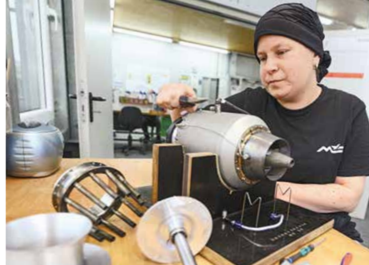
IM JOB: Jennifer Hampe überprüft einen Jet-Antrieb für ein Segelflugzeug.
