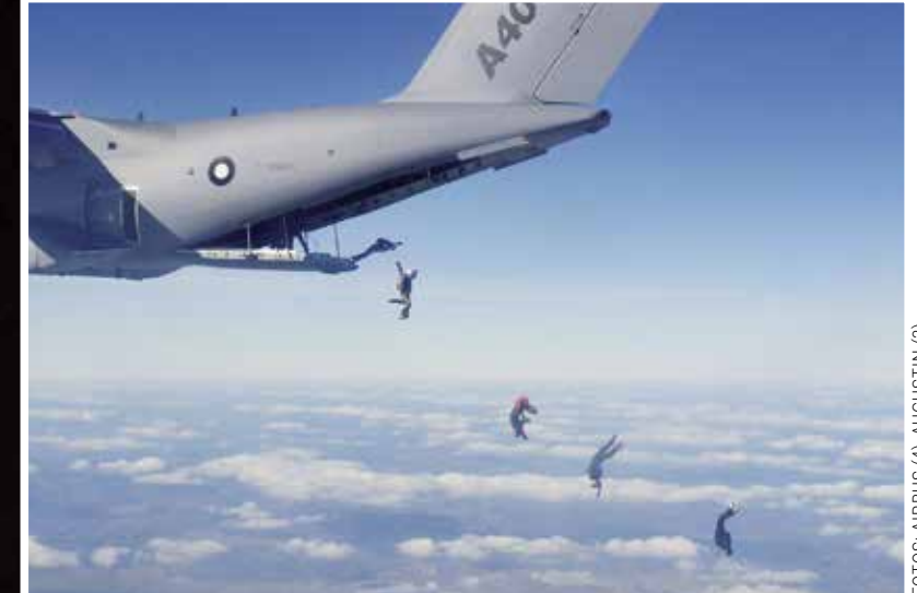
FLIEGENDE ABSPRUNGRAMPE: Bis zu 116 Fallschirmspringer kann die A400M in ihrem geräumigen Rumpf transportieren.
