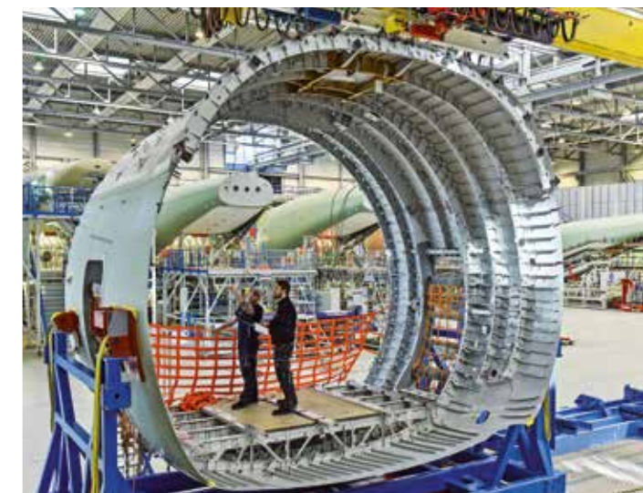
INTEGRIERTE MONTAGE: In Bremen entstehen die A400M-Rümpfe und die Laderampen (links), die später nach Sevilla geflogen werden.
