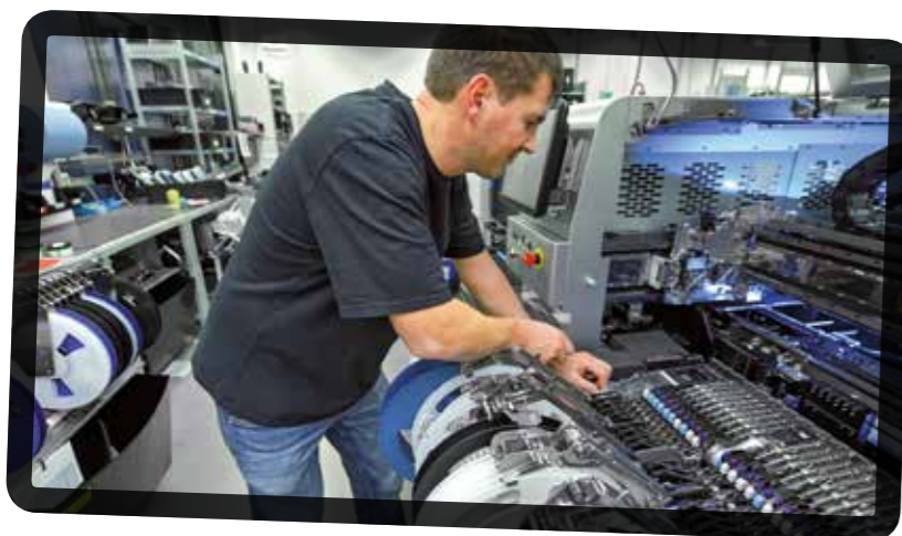
ROLLENWECHSEL: Die Maschine für die Bestückung von Leiterplatten wird neu eingerichtet.
