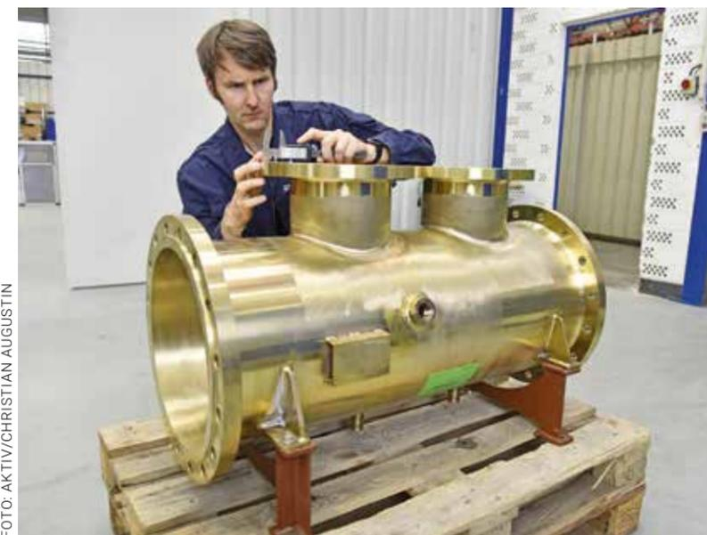
**DAS HERZSTÜCK DER ANLAGE:** Elektroingenieur Jürgen Wetzel an einem Reaktor, in dem das Ballastwasser später mit ultraviolettem Licht behandelt wird.
