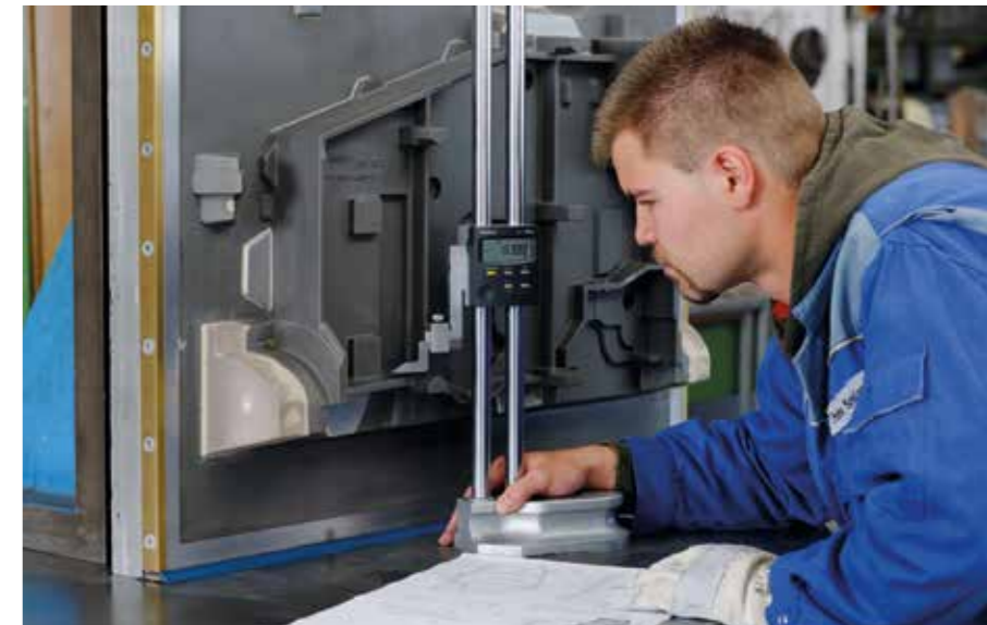
IN DER MODELLBAU-ABTEILUNG: Bevor das flüssige Eisen in die Ofenformen aus gepresstem Sand gegossen werden kann, muss ein Modell entworfen werden.
