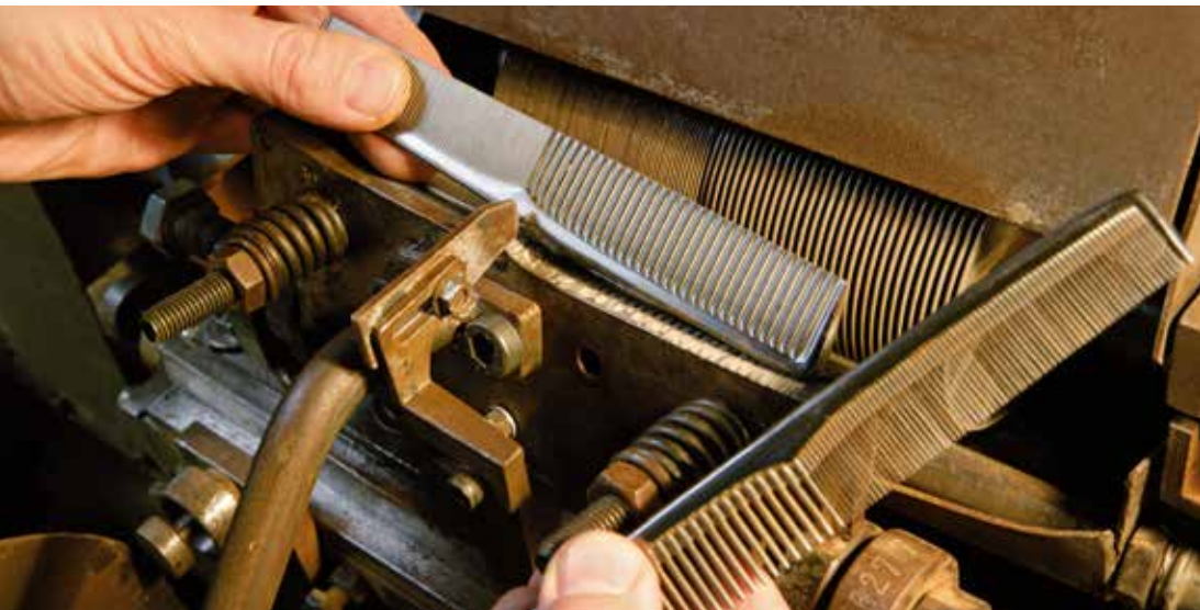
EINER VON VIELEN ARBEITSSCHRITTEN: Hier werden die Zähne in einen Rohling gefräst.
