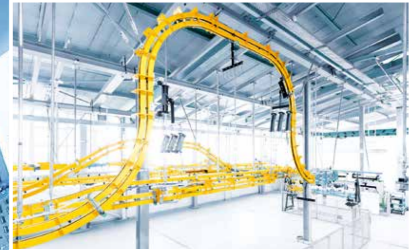
LEISTUNGSSTARK: Die Schierholz-Förderanlagen vom Typ Power & Free können ohne Probleme Steigungen und Gefälle von bis zu 90 Grad bewältigen.
