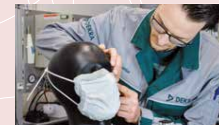
PRÜFSTAND: Im Dekra-Labor in Essen checkt ein Mitarbeiter eine Atemmaske.
