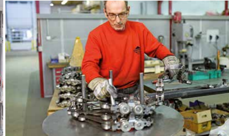
AN IHNEN HANGT ALLES: Mitarbeiter Uwe Weppert montiert Förderketten, die für die Transportanlage in einem großen Unternehmen benötigt werden.
