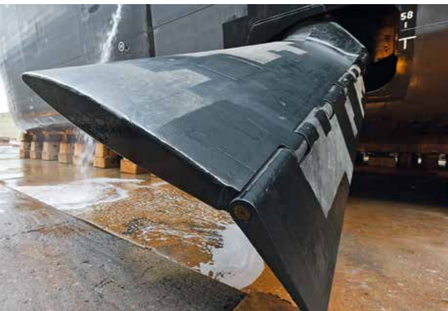
MÄCHTIGE FLOSSE: Tonnenschwere Stabilisatoren am Rumpf verhindern ein „Rollen“ des Schiffes.
