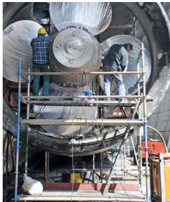
BEEINDRUCKEND: Jeder Propeller hat vier verstellbare Flügel und einen Durchmesser von rund 4,20 Metern.
