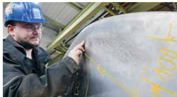
MATERIALSCHADEN: Industriemechaniker Timo Frers prüft, wie stark die Kavitation den Propellern zugesetzt hat.
