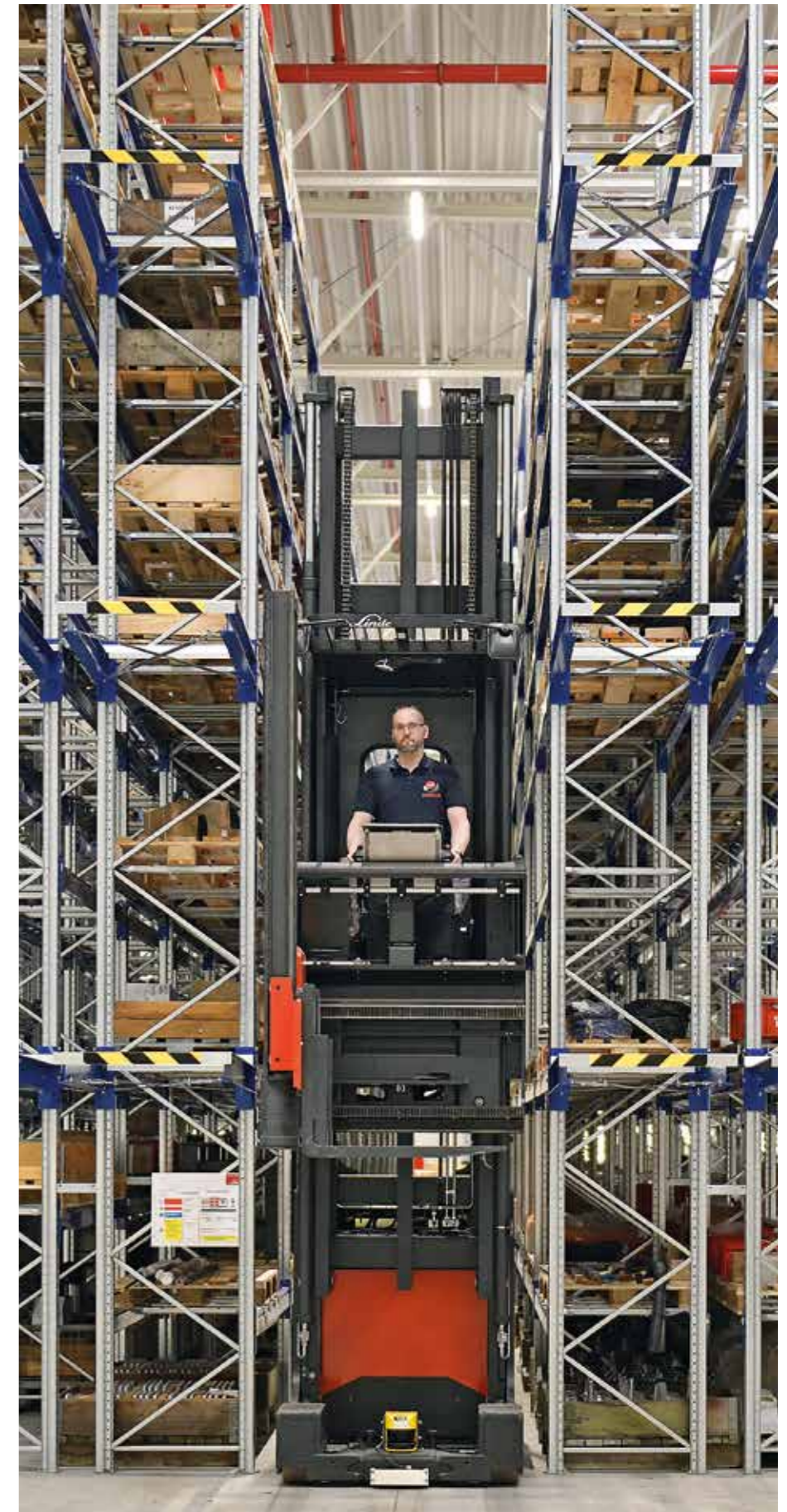
IM LAGER: Die Hochregale im neuen Werk werden mit einem Spezialstapler bestückt.
