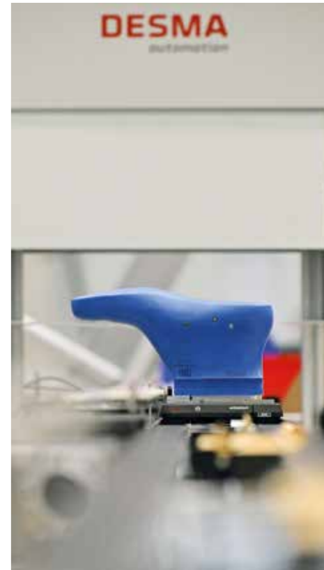
KUNSTSTOFF-LEISTEN: Er bestimmt die Passform des fertigen Schuhs.
