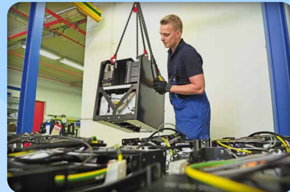
DAS HERZSTÜCK: Mitarbeiter Marc Monsees mit einer Brennstoffzelle, die vor dem Einbau in das Fahrzeug noch einmal mehrere Funktionstests durchläuft.
