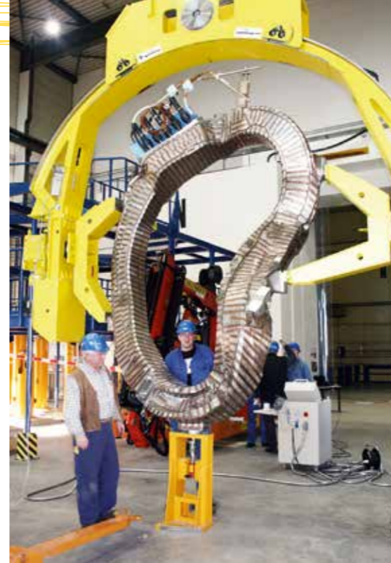
MONTAGEARBEIT: Die erste von insgesamt 50 Spulen, hier eingehängt in ein drehbares Gestell, mit dem die Spulen bei der Montage über das Plasmagefäß gefädelt werden.
