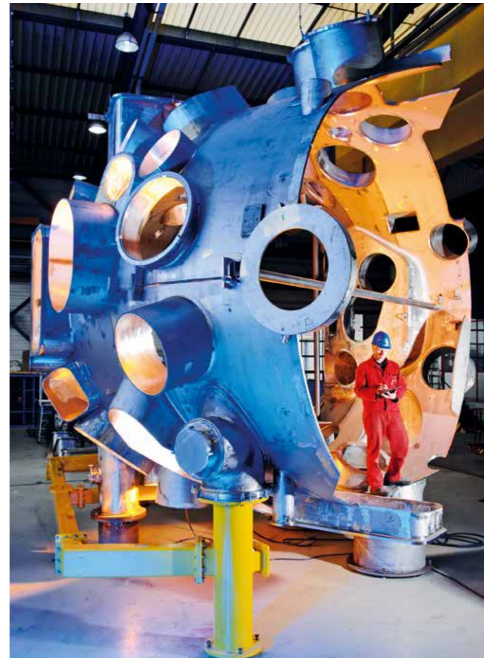
KOMPLEXE KONSTRUKTION: Das über sechs Meter hohe Außengefäß von Wendelstein 7-X.
