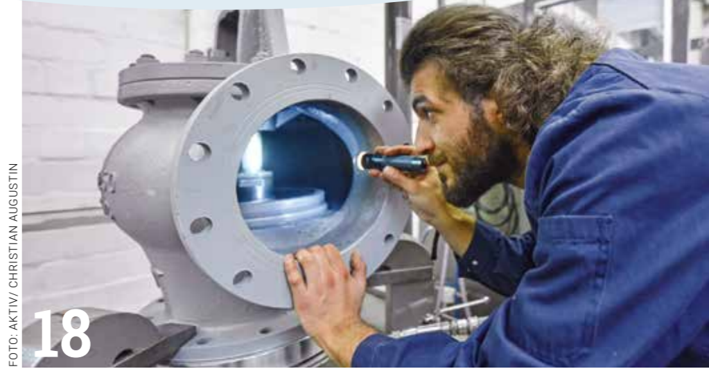
PRÜFENDER BLICK INS INNERE: Schlosser Emrecan Tutak vom Hamburger Unternehmen Fritz Barthel Armaturen prüft ein großes Ventil auf Dichtigkeit.
