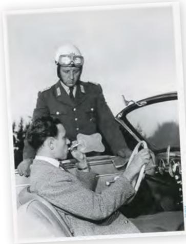
das sich durch die Ethanoldünste in der Atemluft grün verfärbt. Ein simpler Strich auf dem Röhrchen markiert den Promille-Grenzwert, über dem eine Blutprobe fällig wurde. Inzwischen haben sich jedoch Geräte mit elektrochemischen Sensoren durchgesetzt. Bei den modernen Messgeräten mit Digitalanzeige kann der Promillewert auf zwei Stellen hinter dem Komma genau abgelesen werden. Auch hier ist Dräger führend. *DJ*
