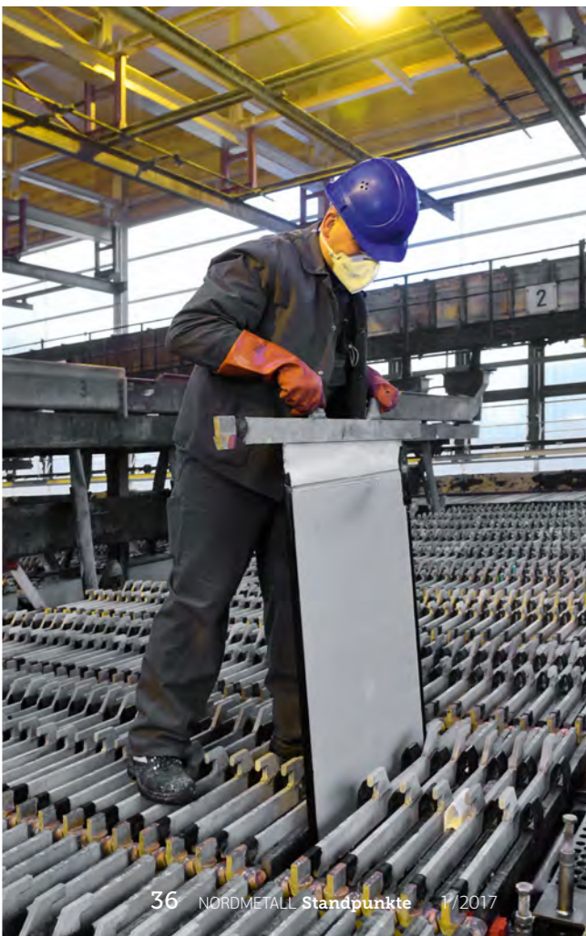
Hier laufen die Prozesssteuerungssysteme auf Hochtouren: Rainer Wahlers (oben) im Gespräch mit dem stellvertretenden Schichtmeister Sven Speckels. In der „Bäderhalle“ (links) kontrolliert ein Arbeiter in Schutzkleidung eine Kathodenplatte.
