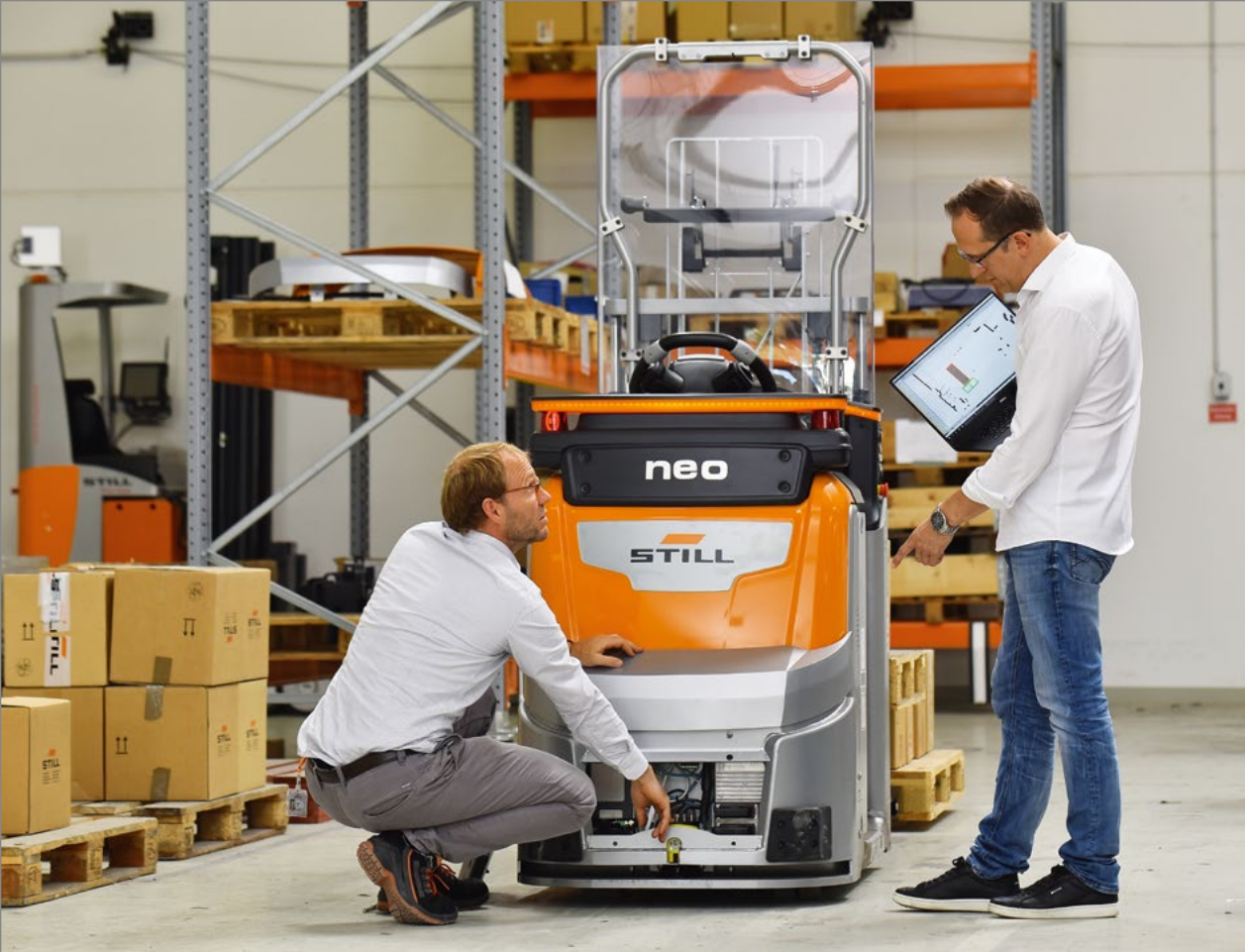
Die Still-Ingenieure Tino Krüger-Basjmeleh (links) und Volker Viereck am Horizontalkommissionierer „OPX iGo neo“, der mit künstlicher Intelligenz ausgestattet wurde. So tasten etwa integrierte Laserscanner 84.000-mal pro Sekunde die Umgebungssituation ab.
