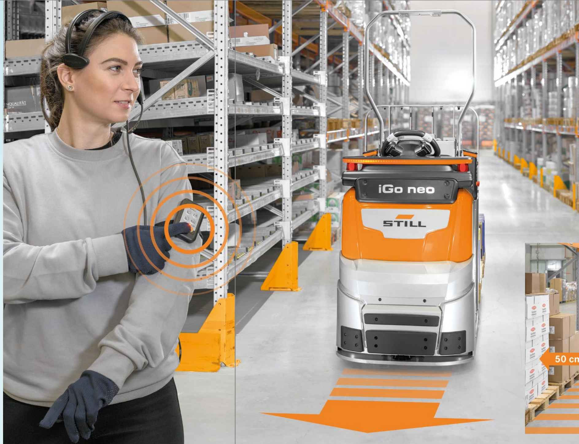
Das intelligente Flurförderzeug OPX iGo neo lässt sich per Knopfdruck fernsteuern, hält vorgegebene Abstände ein und kann Hindernisse auf dem Weg eigenständig umkurven.
