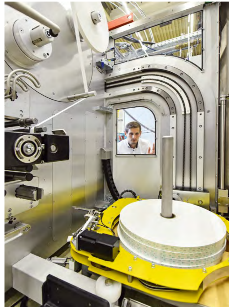
Nachschub: Auf jeder eingespannten Papierrolle sind rund drei Kilometer Papierstreifen aufgewickelt – genug Material für 15.000 Trinkhalme (links).
